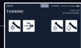
TURBINE LUMIÈRE Réglage de l'intensité de la lumière. Réglage des débits d'air et d'eau des sprays.
